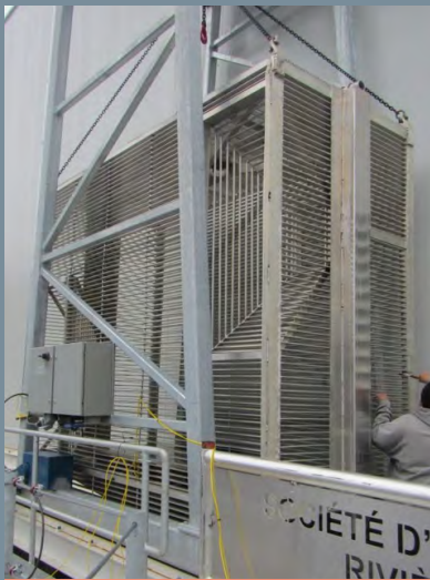
Cage de montaison à la centrale hydroélectrique de Sheldrake, AECOM
